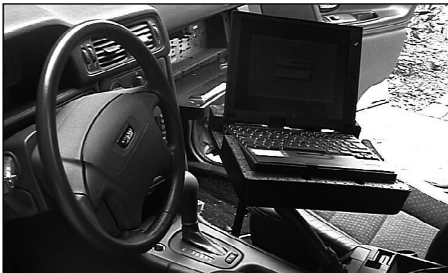
Figure 1 : PC portable supportant le logiciel de diagnostic basé sur la modélisation sur le véhicule de démonstration VOLVO.
